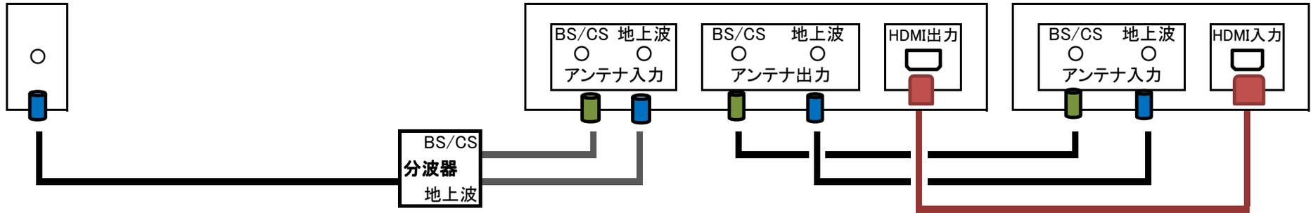
(注) アンテナ端子にBSが入っていない場合は、分波器を使わず屋外のBSアンテナから直接レコーダーのBS/CS端子につなぎます。
